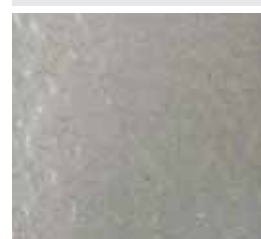
メタルハイドランプ式で促進耐候性試験をした結果、600時間でクラックが入り光沢が失われる。
