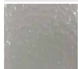
メタルハイドランプ式で促進耐候性試験をした結果、1400時間が過ぎても光沢が失われない。
